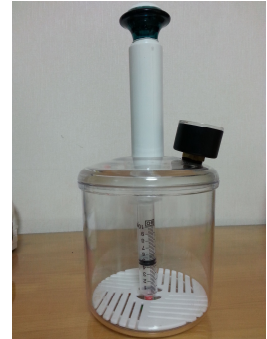
그림 6. 보일법칙 변형주사기 정량실험 장치
