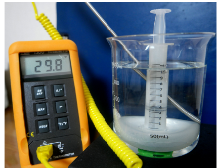
그림 13. 샤를법칙 변형주사기 정량실험 장치
