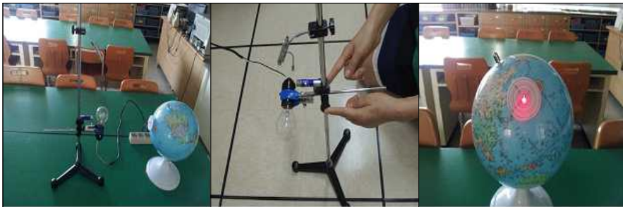
그림-6, 전구와 레이저 포인트가 일직선 되게 설치 그림-7, 레이저 포인트 높낮이 조절장치 그림-8, 태양의 고도그림자 측정
